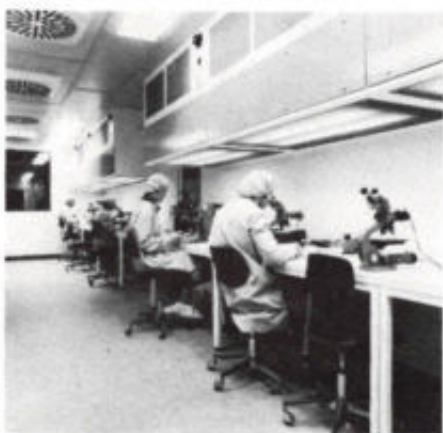
Tussen twee produktiestappen is steeds een inspectie vereist. Deze foto toont een van de ruimten waar medewerkers van Intermetall visuele inspecties uitvoeren met behulp van een microscoop.
