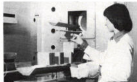
Vervaardiging van positief gedoteerde N-lagen voor zonnecellen bij Telefunken Electronic. Vierkante wafers, hier polykristallijne exemplaren van 10 x 10 cm, worden in een houder van kwarts geplaatst en in een diffusie-oven geschoven. Elke houder bevat ongeveer 300 wafers waarin fosfor wordt gediffundeerd onder een temperatuur van ca. 300 °C.
