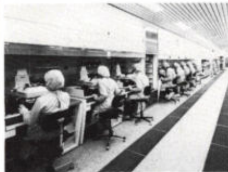
In deze geklimatiseerde ruimte die voldoet aan stofklasse 1 000, worden bewerkte silicium-wafers aan nauwkeurige inspectie onderworpen alvorens verdere verwerking plaatsvindt (foto Telefunken Electronics).
