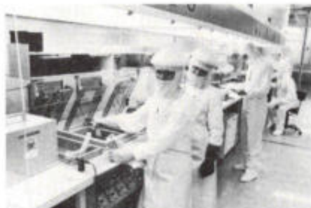
Nat-chemisch etsen van belichte siliciumschijven in Siemens' VLSI-centrum in Villach.
