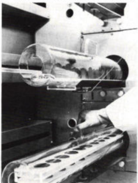
Wafer-belichtingsapparaat, opgesteld in een Nijmeegse "gele kamer".
