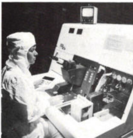
Wafer-belichtingsapparaat, opgesteld in een Nijmeegse "gele kamer".
