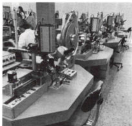
Een klein deel van de productieruimte waar de gouddraadjes aan de chips worden gehecht. Evenals de testapparatuur, zijn deze wirebonding-automaten een eigen ontwikkeling van Intermetall.
