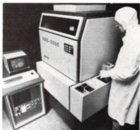
Waferstepper PAS-2000: een eigen product van Philips, dat maskerpatronen met 1,5 \mu m-structuren kan afbeelden met een snelheid van ongeveer 200 stappen per minuut.
